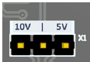
Рис. 3. Переключатель для выбора диапазона внешнего аналогового сигнала
